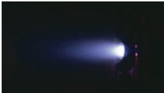
Photo du propulseur miniaturisé de ThrustMe en opérations dans leur banc d'essai à Verrières-le-Buisson. Ce propulseur sera pleinement développé grâce à TREND.
