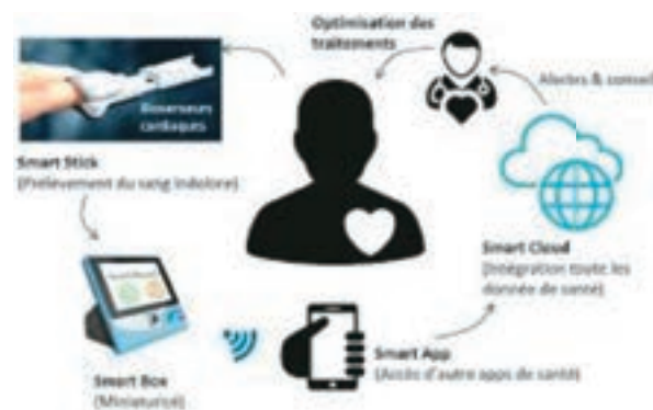
Illustration du projet IMPACT : une nouvelle boucle de télémédecine d'insuffisance cardiaque composée de Smart Stick, Smart Box, Smart App et Smart Cloud, qui met les patients au centre de leur thérapie
