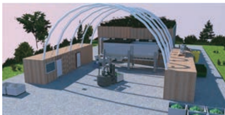
Représentation en image de synthèse de l'unité de micro-méthanisation multi-conteneurs de TRYON
