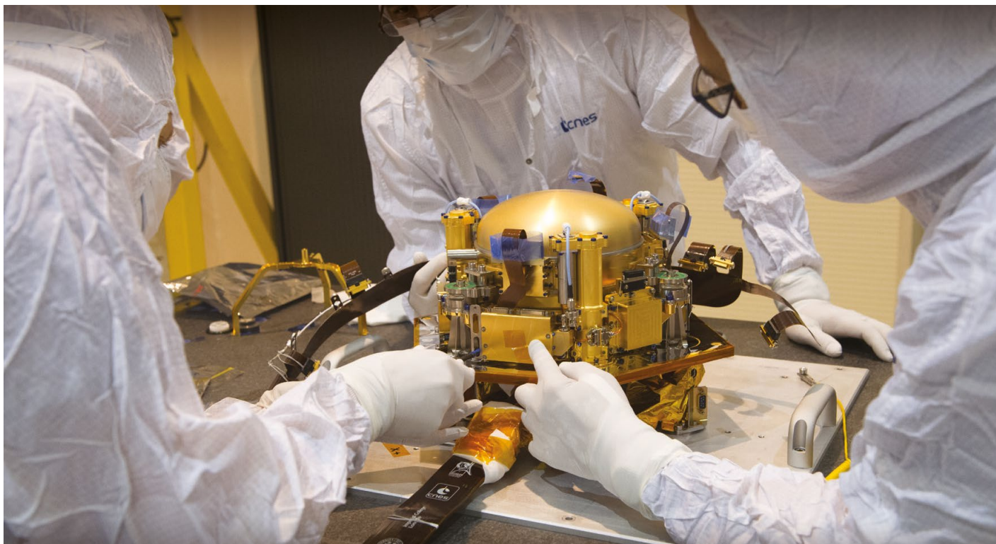
Intégration du sismomètre SEIS au Centre spatial de Toulouse
